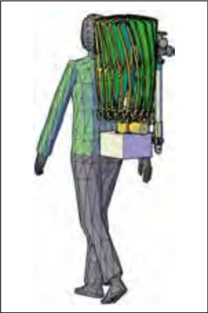
Abb. 2: Antennensystem in Transportkonfiguration
