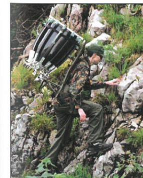
Abb. 4: Rucksacksystem der KEAN Antenne zum einfachen Transport in steilem und unwegsamem Gelände (Quelle: HPS GmbH)
