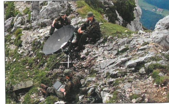
Abb. 3: Satellitenkommunikation mit der KEAN Antenne in unwegsamem Gelände (Quelle: HPS GmbH)
