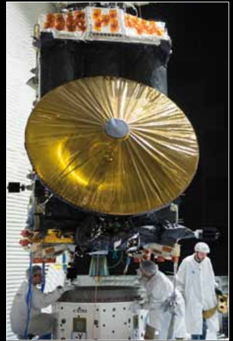
ExoMars 2016: Der Trace Gas Orbiter und Landedemonstrator Schiaparelli mit dem unteren Thermalschutzanzug
