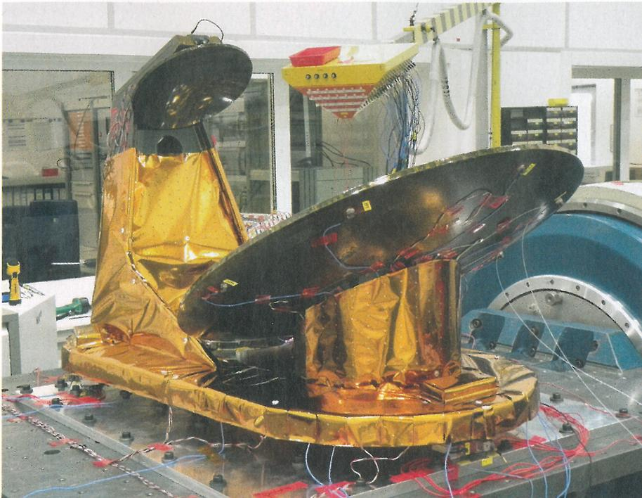
Höchste Präzision gefordert: Vibrationstest von Satelliten-Antennen
