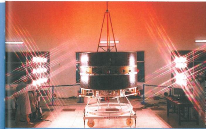
DOUBLE STAR TC-2-Satellit während eines Sonnensimulationstests: Die Astro- und Feinwerktechnik Adlershof GmbH war an Entwicklung, Bau und Verifikation der entfaltbaren Booms des Satelliten beteiligt.
