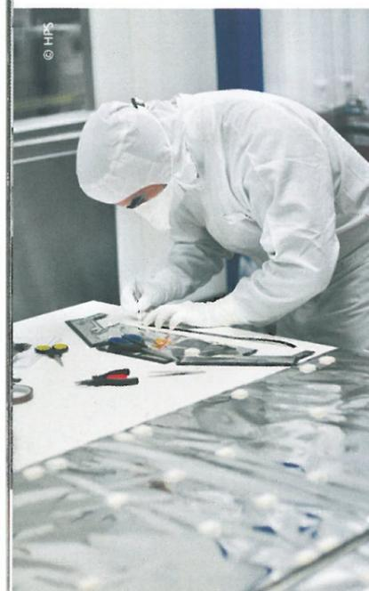
MLI-Fertigung bei HPS: Die Firma entwickelt, fertigt und integriert unter anderem die Isolation für das deutsche Teleskop eROSITA von MPE.
